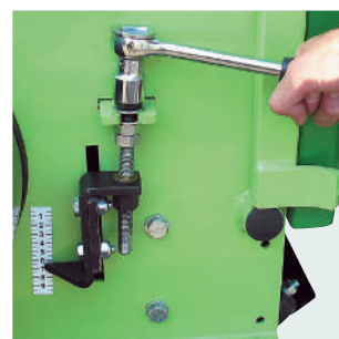
Regolazione di taglio millimetrica. Millimeter cutting adjustment.
