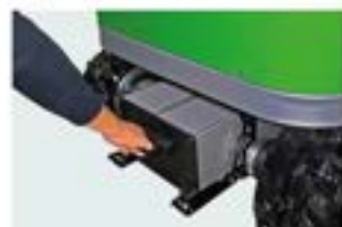
Batteria intercambiabile. Interchangeable battery. 10 kWh
