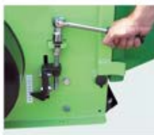
Regolazione di taglio millimetrica. Millimeter cutting adjustment.
