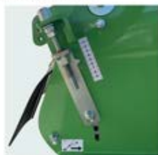
Facile regolazione rullo. Easy roller adjustment.
