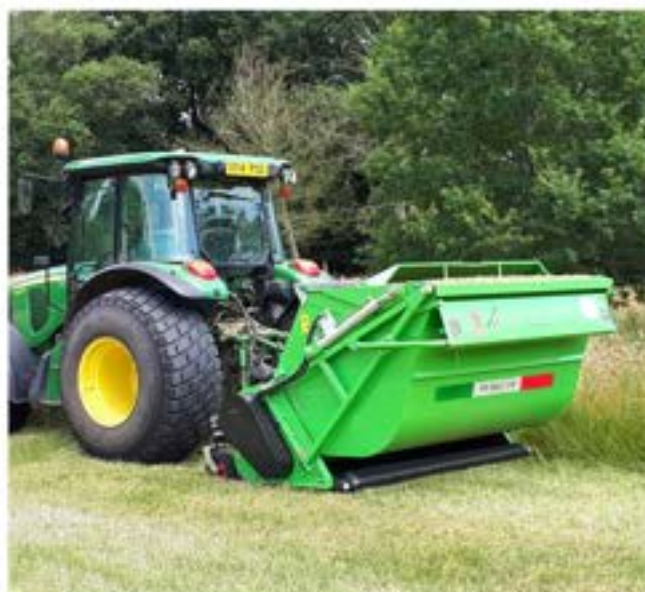
Scenico idraulico oltre 2 mt High lift discharge up to 2 mt
