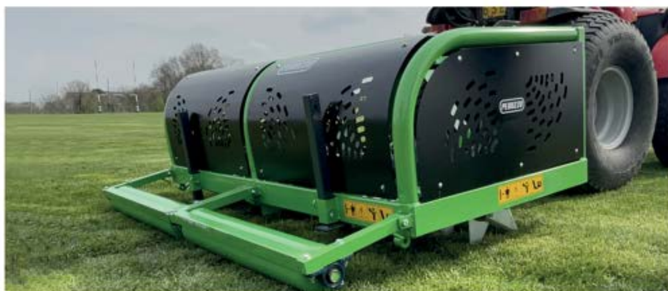
Pianale superiore per posizionamento peso per una migliore taglio in profondità a seconda del terreno. Upper platform for weight positioning for better cutting depth depending on soil compaction.
