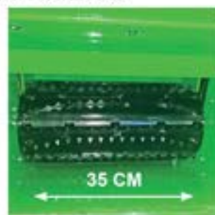
Rullo di alimentazione (350 mm x 150 mm). Feeding roller (350 mm x 150 mm).
