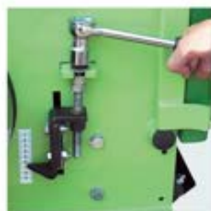
Regolazione di taglio millimetrica. Millimeter cutting adjustment.
