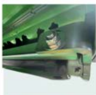
Rullo + raschiarullo. Roller + scraper.
