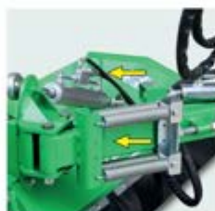
Valvola idraulica e Molle protezione trincia in caso di urto. Hydraulic valve and springs for mower protection in case of impact.
