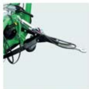
Timone di trasporto e per il taglio in presenza di ostacoli. Drawbar for transport and cutting in the presence of obstacles.
